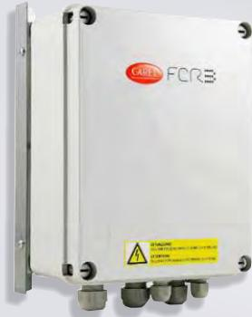
در تمامی چیلرهای هوا خنک ساخت شرکت پویش تهويه، جهت تغيير سرعت چرخش الکتروفن های کندانسور از بُردهای کنترلی مخصوصی به نام FCR استفاده می شود. محصولی مختص فن های محوري روتور خارجي که با کنترل حجم هوادهی فن ها باعث می شود علاوه بر عملکرد پایدار کندانسور، مصرف برق ناشی از فرایند کندانسینگ بهينه گردد. همچنین کاهش دور فن در ساعت پایانی و ابتدایی شبانه روز که ميزان صدای تولیدي چيلر از اهميت بيشرى برخوردار است (خصوصاً در چيلرهای بزرگتر)، کمک شاياني به کاهش انتشار صدا خواهد كرد.
